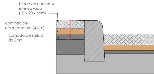
DETALHAMENTO MEIO-FIO SEM ESCALA
