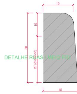
OBS.: deverão ser empregados meios-fios de concreto pré-moldado entre a via e o passeio público para **fixação dos blocos de concreto intertravado**. Os meios-fios deverão ter  $\frac{1}{3}$  de altura aterrados, conforme indicado.
