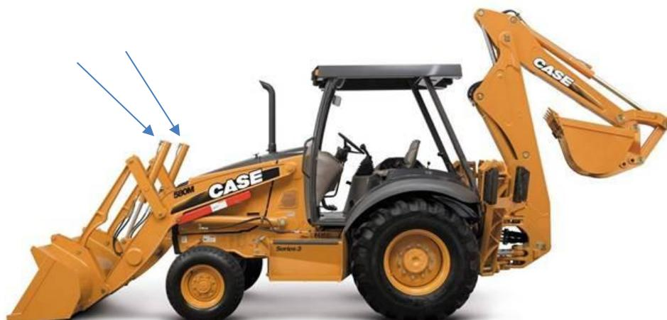
**CAÇAMBA COM UM CILINDRO DE NIVELAMENTO:**
